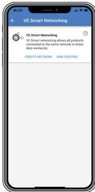
Mit dem VE.Smart-Netzwerk können verschiedene Produkte, die mit demselben Netzwerk verbunden sind, Daten über Bluetooth austauschen. VE.Smart ist speziell für kleinere Anlagen geeignet, in denen kein GX-Gerät installiert ist.
