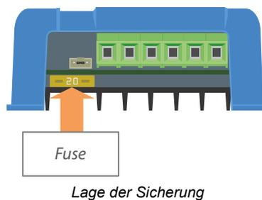
Entfernen Sie die Sicherung, um den Sicherungsdurchgang zu prüfen. Falls die Sicherung defekt ist, tauschen Sie die Sicherung gegen eine neue Sicherung aus. Prüfen Sie jedoch vor dem Einsetzen der neuen Sicherung die Polarität der Batterie und beheben Sie diese, falls falsch gepolt wurde.
