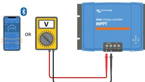
2. Verwenden Sie ein Multimeter, um die Spannung an den Batterieklemmen zu messen.
