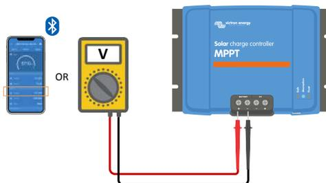
2. Messen Sie die Batteriespannung an den Klemmen der Batterie mit einem Multimeter.
