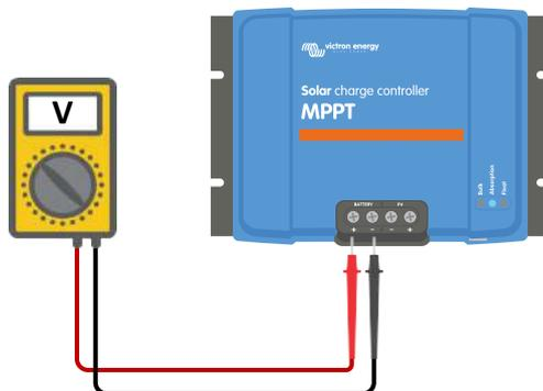
*Messen der Batteriespannung an den Batterieklemmen des Reglers*
