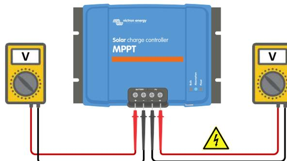
3. Vergleichen Sie beide Spannungen, die PV-Spannung muss 5V höher sein als die Batteriespannung, um den Ladevorgang zu starten.
